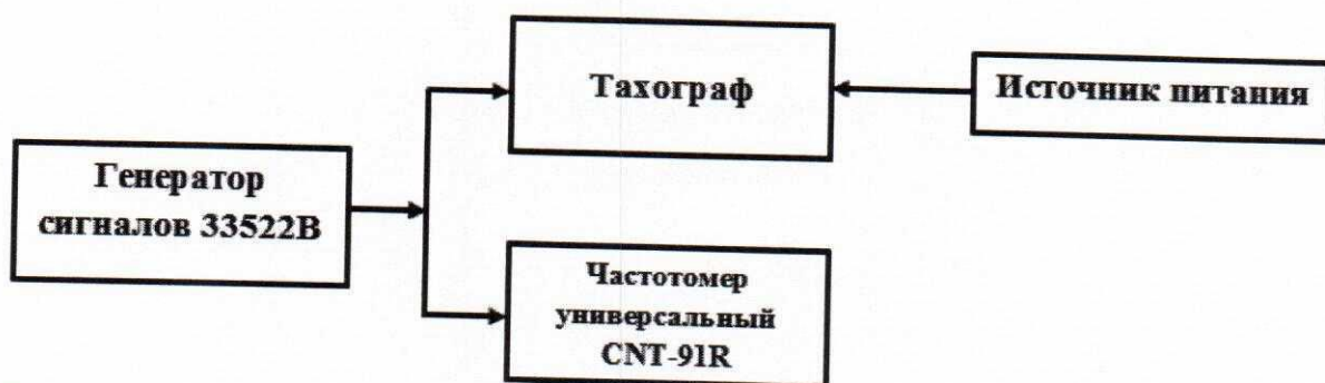
Рисунок 2 – Схема проведения измерений при определении погрешности измерений интервала времени и инструментальной погрешности пройденного пути
