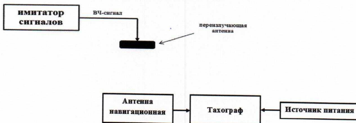
Рисунок 3 – Схема проведения измерений при определении инструментальной погрешности измерений скорости по сигналам ГНСС ГЛОНАСС/GPS
