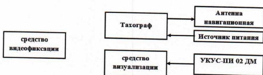
Рисунок 6 - Схема проведения измерений при определении абсолютной погрешности синхронизации шкалы времени внутреннего опорного генератора тахографа с национальной шкалой координированного времени UTC(SU)
