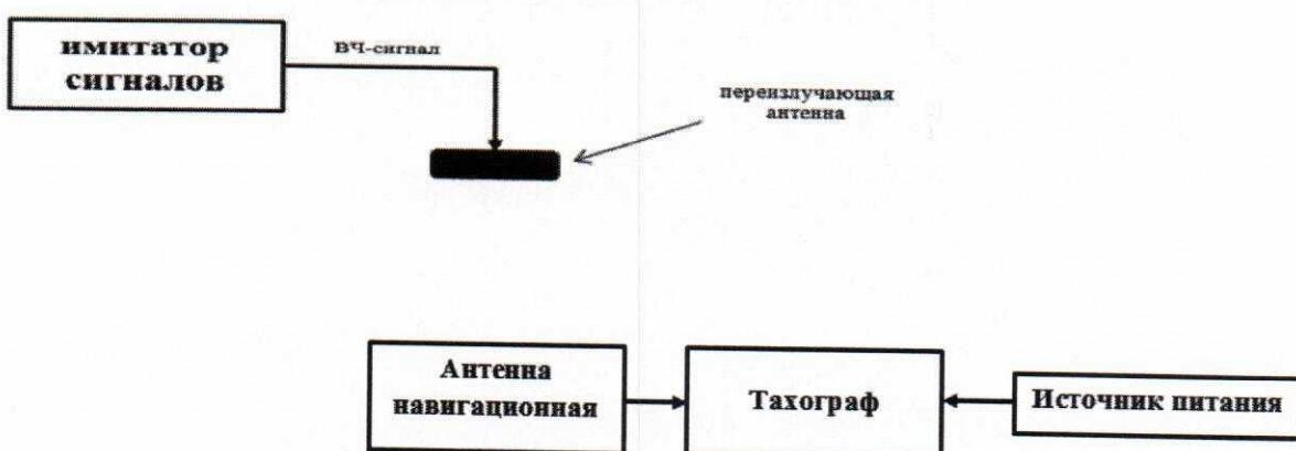
Рисунок 3 – Схема проведения измерений при определении погрешности измерений скорости по сигналам ГНСС и инструментальной погрешности определения координат
